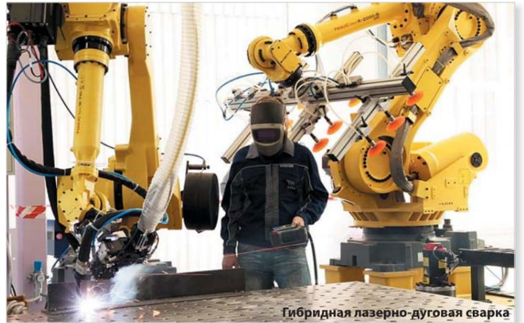
Гибридная лазерно-дуговая сварка
