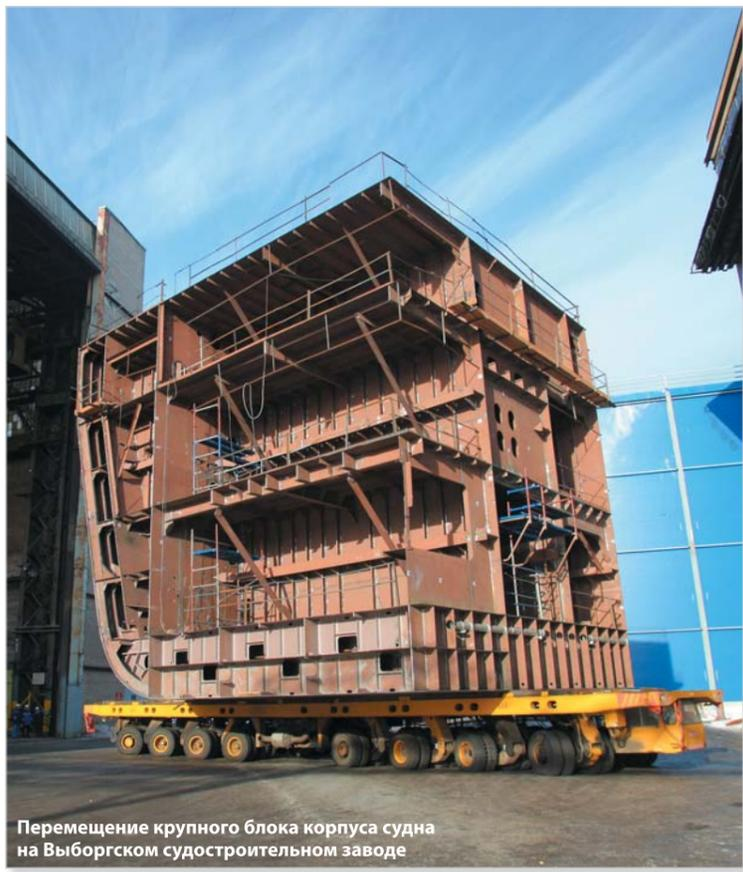
Перемещение крупного блока корпуса судна на Выборгском судостроительном заводе
