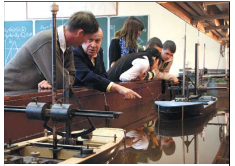
Зав. лабораторией кафедры Теории корабля, капитан 1-го ранга В.Г. Луговых ведет опыты кренования судов со студентами-гидроаэромеханиками в зале малых установок
