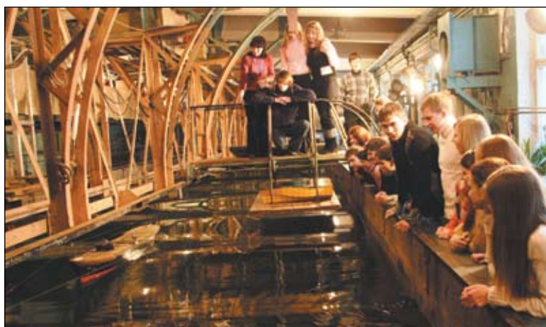
Лабораторная работа для студентов-кораблестроителей по исследованию продольной качки модели судна в опытном бассейне им. акад. А.Н. Крылова кафедры Теории корабля. Фото Сергея ДОВГЯЛЛО
