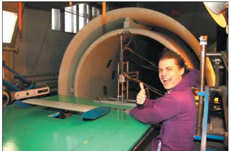
Студент специальности Гидроаэродинамика А. Шалада измеряет поле давлений во время продувки крыла в аэродинамической трубе кафедры Гидроаэростроения и морской акустики. Все три фото В. Горшелева
