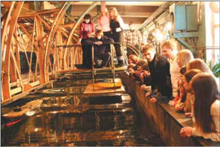
Студенты-кораблестроители исследуют продольную качку буксируемой модели судна в опытном бассейне им. акад. А.Н. Крылова кафедры Теории корабля. Фото С. Довгялло
