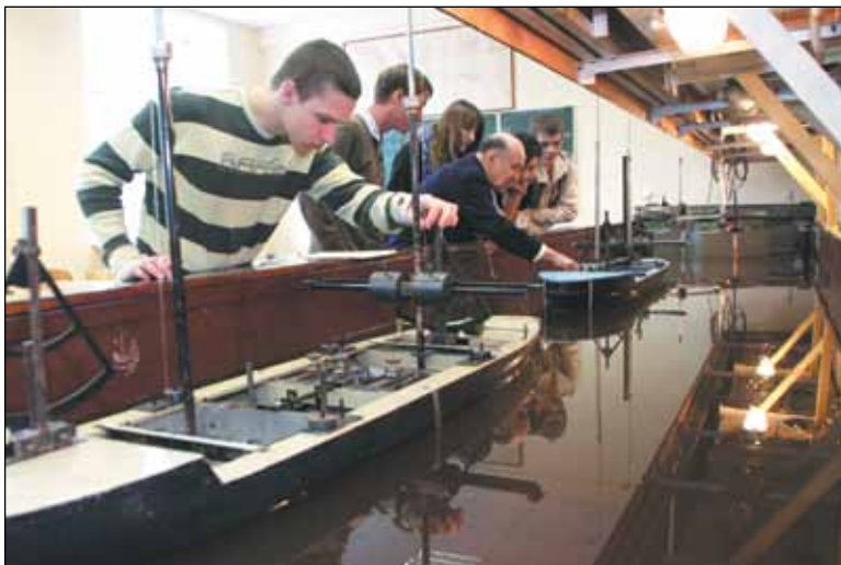
Студенты-гидроаэродинамики выполняют кренование модели судна в зале малых установок кафедры Теории корабля под руководством зав. лабораторией, капитана 1 ранга В.Г. Луговых
