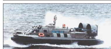
Патрульный катер на воздушной подушке «Чилим», проект 20910, главный конструктор – В.А. Абрамовский
