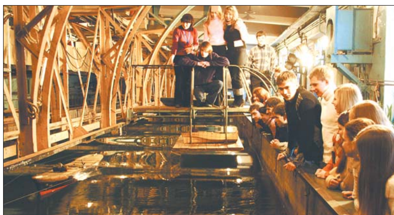
Лабораторная работа для студентов-гидроаэродинамиков по исследованию продольной качки модели судна в опытовом бассейне им. акад. А.Н. Крылова кафедры Теории корабля. Фото Сергея ДОВГЯЛЛО
