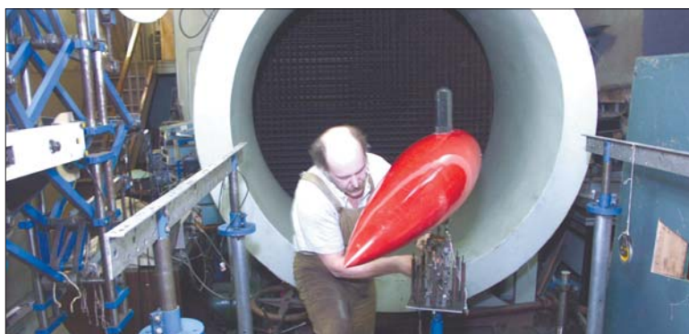
Дозвуковая аэродинамическая труба кафедры ГАММА вступила в строй в 1961 г. Заведующий лабораторией П.Н. Замятин. Мощность силовой установки трубы 250 кВт, диаметр сопла 1 750 мм, расчетная скорость потока в рабочей части 60 м/с.
