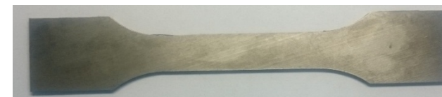
Образец для механических испытаний ГОСТ 11701-84
