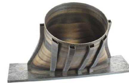
Cubierta exterior de colector de gas GTE-65.1 Acero inoxidable. Peso - 33 kg. Tiempo de fabricación - 56 horas.
