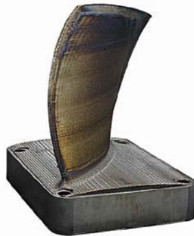
Pala. Acero inoxidable. Peso - 45 kg. Tiempo de fabricación - 60 horas.
