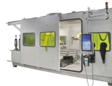
ILWT-2XL – dimensiones de piezas fabricadas: Ø 2200 mm, h – 1000 mm, peso – hasta 8000 kg.
