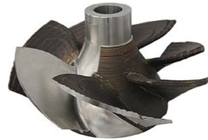
Pieza bruta de la hélice de propulsor de agua. Acero inoxidable. Peso - 27 kg. Tiempo de fabricación - 32 horas. Se muestra el mecanizado de acabado.
