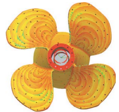
Tensiones residuales (simulación)
