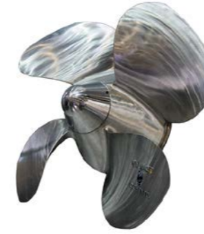
Hélice con palas huecas topológicamente optimizadas. Acero inoxidable. Peso - 160 kg. Tiempo de fabricación - 100 horas.
