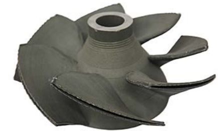
Pieza bruta de la hélice de propulsor de agua con palas huecas. Acero inoxidable. Peso - 17 kg. Tiempo de fabricación - 16 horas.
