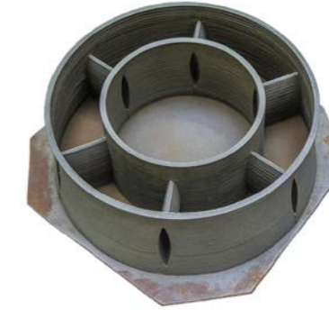
Elemento de motor de turbina de gas. Aleación de níquel resistente al calor. Peso - 23 kg. Tiempo de fabricación - 29 horas.
