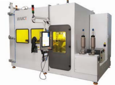
ILWT-XL – dimensiones de piezas fabricadas: Ø 2200 mm, h – 600 mm, peso – hasta 1200 kg.
