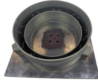
Anillo de entrada de colector de gas GTE-65.1 Aleación de níquel resistente al calor. Peso - 15 kg. Tiempo de fabricación - 37 horas.
