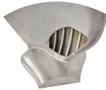
La pala topológicamente optimizada de la hélice de propulsor de agua. Acero inoxidable. Peso - 12 kg. Tiempo de fabricación - 12 horas.
