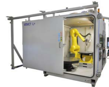
ILWT-L+ – dimensiones de piezas fabricadas: Ø 1500 mm, h – 1000 mm, peso – hasta 1000 kg.
